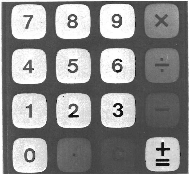
Tastiera di un calcolatore a quattro funzioni. Eseguendo alcuni passaggi intermedi si possono risolvere operazioni maggiormente complesse come appunto l'estrazione della radice quadrata.
